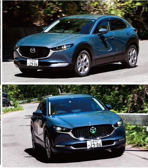
走り出してみて驚いたのは、2リッターガソリンエンジンの軽快さと扱いやすさ。最高出力156ps／最大トルク20.3kgmと数値上は凡庸だが、体感上はもつとスポーティだ。街中での出足に不満を感じる場面はなく、むしろ気持ち良いと感じる範囲で踏んでいくと、気づけば車群をリードしている。ディーゼルターボより低中域のトルク感はないが、その分、回転で補ってくれるイメージだ。
