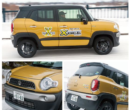
く反映されている。スイッチ一つでスポーツ／スノー／グリップ／コントロール／ヒルディセントコントロールという4つのモードを選択できる。スポーツはエンジン回転数を高めにキープして俊敏な運動性能を。スノーではトルクを抑制してタイヤの空転を抑える。グリップ／コントロールはぬかるみやザクザクの雪道などにおいて空転しているタイヤをブレーキ制御する一方、グリップしているタイヤに駆動力を集中させるデフロックのような機能。ヒルディセントコントロールは急な下り坂において車速を約7km/hに維持する機能である。どのモードも選択していない通常モードはいわゆるエコモードながら、アクセルを踏めば軽快な加速を見てくれる。
