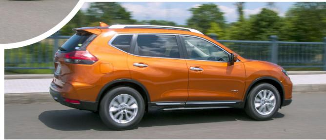
今回の試乗は高速道路からはじめた。というのも車線逸脱防止支援システム、ぶらつき防止警報、そしてもう一つどうしても試したい機能があるからだ。それは「プロパイロット（高速道路同一車線自動運転技術）」。5代目セレナで初採用された機能で、高速道路上において、前車との距離や左右の白線との距離を検知しながら、アクセル・ブレーキ・ステアリングのすべてを自動的に制御するメーカーオプションだ。料金所を過ぎ、アクセルをやや踏み込むと、スムーズに加速。軽快に回るリッターエンジンにモーターのトルクが加わることで、非力さは全く感じられない。カメラマンの車両に先行してもらい、その後ろについてプロパイロットを起動させる。とは言つても、ステアリング右手側にあるボタンを2つ押すだけ。インパネ中央のディスプレイに自車と先行車のイラストが現れ、システムが働いていることがわかる。
