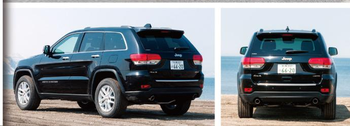
現行のWK型、2011年6月から販売が開始されたのだが、その時点ではタイムラー・クライスラーだったため、基本のプラットフォームはメルセデス・ベンツのMクラスと共通である。さらに、そのベンツ系の技術を生かしてサスペンションにもJeep史上初めて、このWK型グランドチェロキーには金属スプリングを使わないエアサスが導入されている。その後、何度かマイナーチェンジされたが基本の車体構造は変わっていない。舗装路面での静粛性やロードホールディングの好印象はそのあたりが生きているのだろう。
