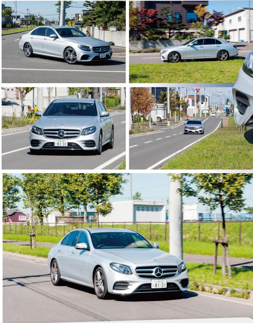
ボーツ。排気量1991ccのターボチャージー付き直列4気筒DOHCエンジンを搭載するE200アバンギャルドをベースに、前後バンパー・や19インチアルミホイール、スポーツステアリングなどにAMGデザインによるものを採用し、ステンレス製ペダルも備えるなど、スポーティーにドレスアップしている。ちなみに、E200にはこのほか4MATICアバンギャルドが配備されている。
