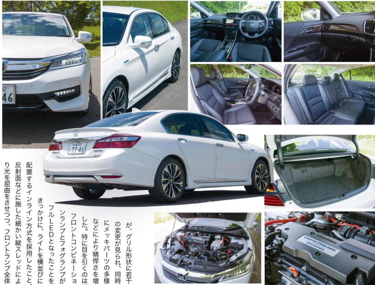
配置するインライン方式を採用したこと。反射面などに施した細かい縦スレッドにより光を屈曲をさせつつ、フロントランプ全体が、グリル形状に若干の変更が見られ、同時にメッキパーツの多様などにより精悍さを増した。特に目を引くのはフロントコンベネーションランプとフォグランプがフルLEDとなったことをきっかけに、ライトを横並びに
