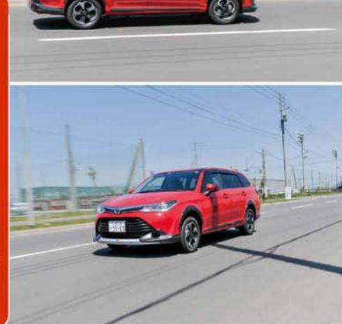
コーナードでの挙動も安定感に富んでおり、欠点らしい欠点は見当たらない。低速で急カーブを曲がる際のハンドリングもイメージで、最小回転半径4.9m（一部グレードは5.5m）と、このサイズのクルマとしては非常に小回りの効く設計となっていることがリアルに感じられる。この特性は、当然ながら混雑する街路や駐車場でいかに発揮される。縦列駐車もバックで空きスペースにクルマを収める際にも取り回しが非常に楽で、軽自動車並
