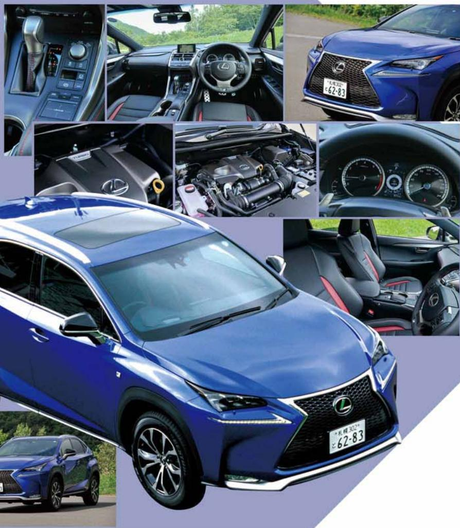
搭載されるワーニングは2.0ターボと2.5ハイブリッドの2タイプ。このうちニュースは、水冷式エキゾーストマニホールド一体シリンドラヘッドとツインスクロール・ターボチャージャーを組み合わせた新開発2.0ユニット。吸排気のバルブ・タイミングを最適制御するVVT-i-wやアイドリングストップ機能も備え、238ps/35.7kg·mの最高出力
