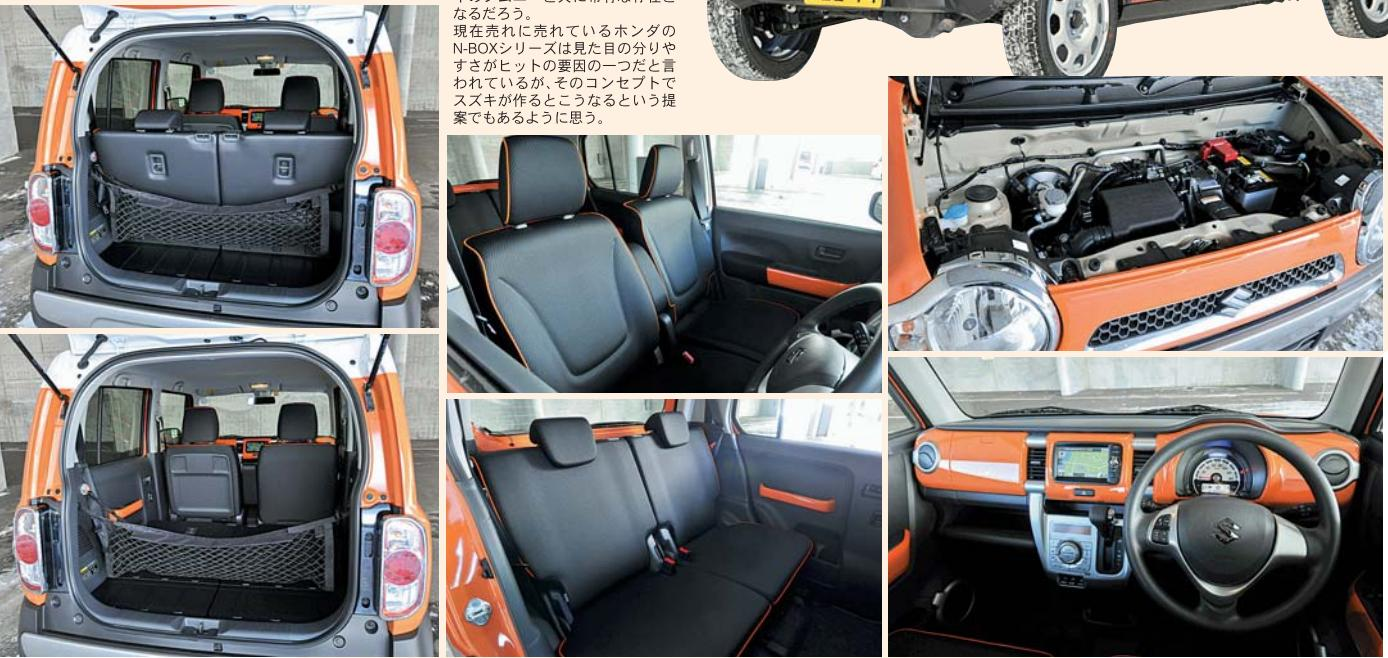
は2,425mmで、全高以外はワゴンRおよび派生型の車種と共通である。エンジンも同様、658cc直列3気筒 DOHC 12バルブVVTの自然吸気とインタークーラーターボの2本立て。このエンジンはNAでもともと活発で、ターボとともに軽であることをすっかり忘れるほどの元気がやりである。しかもトルクフルで使いやすい。最大トルクはターボで3,000rpm、N/Aで4,000rpmなど、実用性を考慮した特性を持っている。
