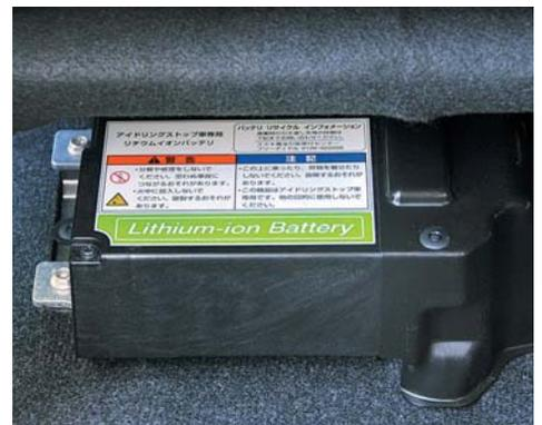
スイフトに搭載されているリチウムイオンバッテリー。減速時にこのバッテリーに蓄電され、車内の電気系統へ供給されている。通常のクルマはエアコンなど電力を大量に消費する機器が作動するとエンジン回転を上げて発電するが、エネチャージで減速時に充電することこのクルマの場合は、電装品が作動してもエンジン回転には影響を与えないためガソリン消費量が少なくなり、結果として燃費が向上する。
