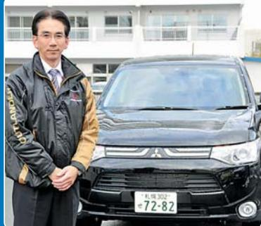
エンジンを搭載する2WDバージョンと、2.4ℓ・169ps / 6000rpmを発生する同系エンジンを乗せた4WDバージョンの2タイプ。エンジン性能そのものに先代との大きな違いはないが、ボディやパーツの徹底した見直しにより全重量が90kgから100kg軽くなっている。これが、操作性にも好影響を及ぼしていることは、先代ユーザーならすぐに分かるはず。また、比較検討を待つまでもなく優れたドライブフィールが備わった車であることが実感できよう。
