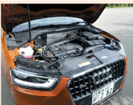
2.0 TFSI 4気筒180馬力を誇る直列4気筒ターボエンジンが搭載されている。6速DSGの6速自動変速機と組み合わせることで、少ない燃費で高い燃費効率を実現する。
